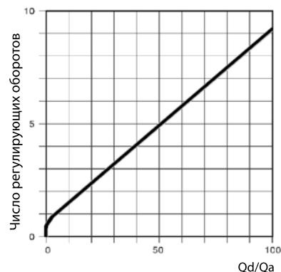
Зависимость коэффициента затекания теплоносителя от количества оборотов регулирующей ручки.
