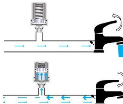
При закрытии потребителя давление в трубопроводе увеличивается и компенсатор гидроударов FAR поглощает избыточное давление, обеспечивая защиту компонентов системы.
