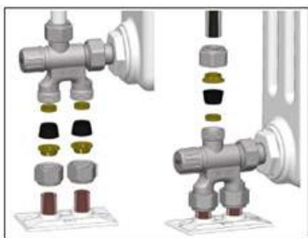
Пример установки с использованием концовок (код 8427, 8429) для медных труб.
