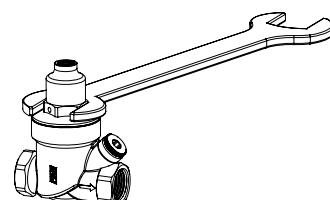
3) Используя ключ 25 мм снять колпак
