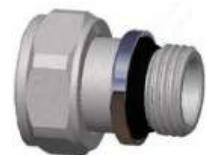
Тип 2 – с уплотнительным кольцом на штуцере из EPDM и подвижной шайбой, исключающей заминание кольца при присоединении к отопительному прибору.
