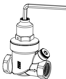
2) Повернуть монтажный ключ 5 мм против часовой стрелки и вытащить пружину
