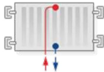
У трубчатых радиаторов DeLonghi Multicolonna подающий и обратный теплопроводы подсоединяются к нижнему коллектору, но перегородкой разделяется циркуляция по потока.
