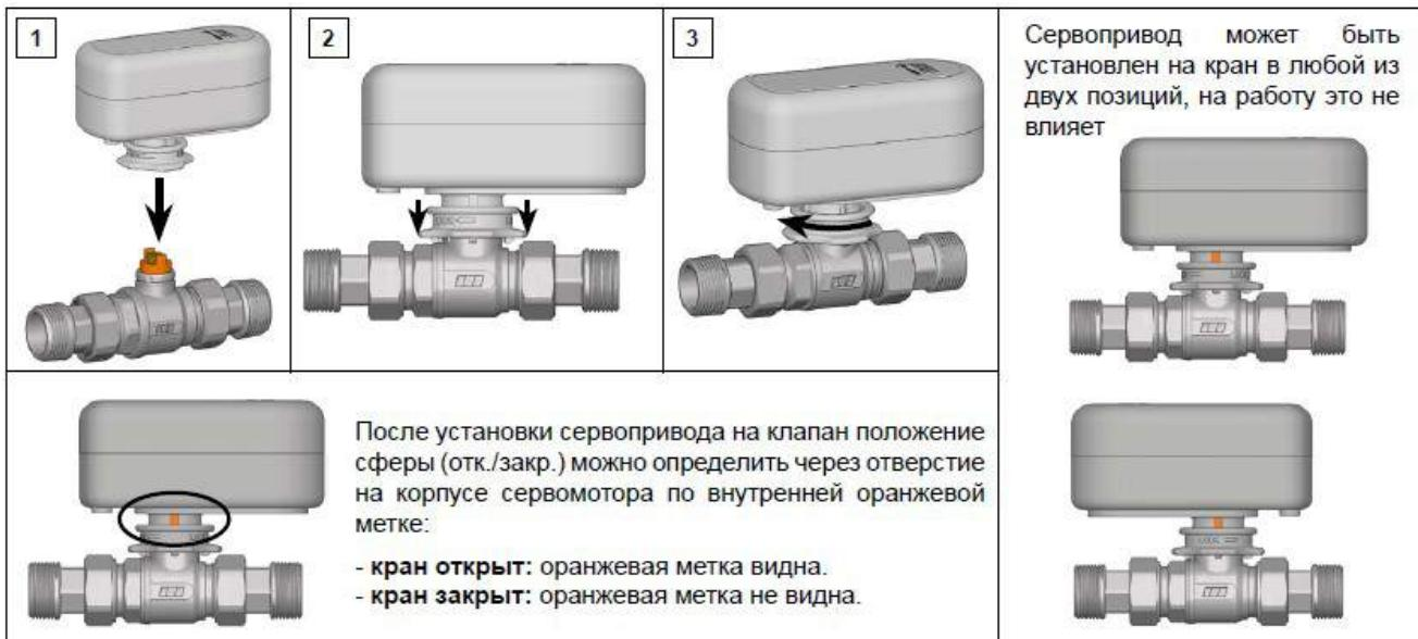
После установки сервопривода на клапан положение сферы (отк./закр.) можно определить через отверстие на корпусе сервомотора по внутренней оранжевой метке:
