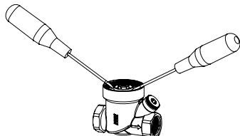
4) Для извлечения картриджа установите две отвертки под металлический диск и нажмите на отвертки вниз
