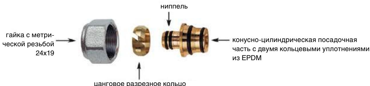
**Концовка FAR для металлопластиковых труб и труб PEX (код 6055)** с накидной гайкой с резьбой M24x19 имеет несколько отличительных преимуществ от стандартных концовок (типа eurokonus):
