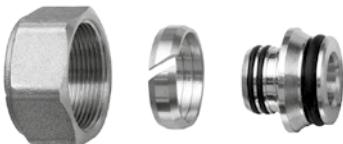
К отводам коллектора (код 3827), имеющим метрическую резьбу 33x1.5, **концовками FAR** (код 6056) **напрямую подсоединяются** металлопластиковые трубы 20х2, 20х2.25, 20х2.5, 26х3. Подсоединение металлопластиковой трубы 26х3 дает возможность прямо от коллектора делать разводку стояков и магистралей с допустимым расходом до 1100 кг/ч, при котором скорость теплоносителя не превышает 1 м/с.
