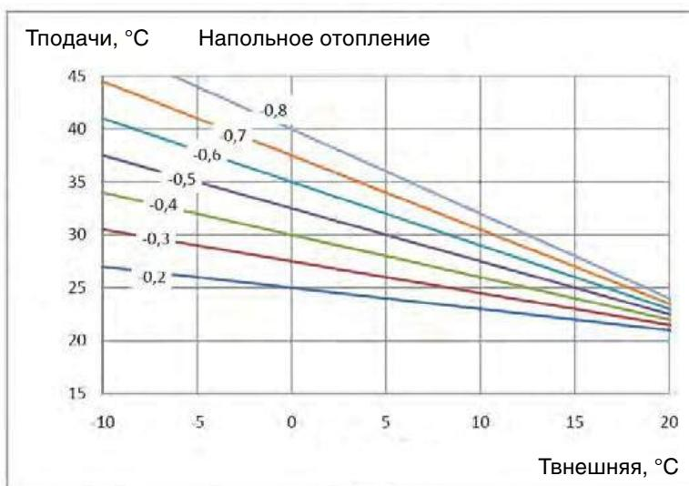
C04 – наклон кривой регулирования (возможные значения: -0,2 -0,3 -0,4 -0,5 -0,6 -0,7 -0,8) C21 - минимальная температура потока
