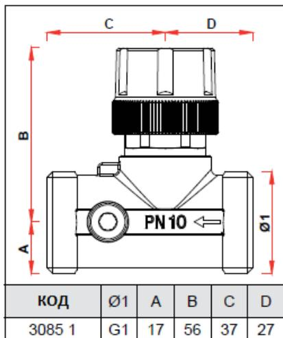
В отверстии для температурного зонда коническая резьба W 10x19
