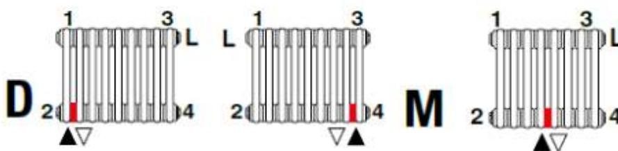
У медно-алюминиевых конвекторов упрощается гарнитура термостатического подключения:
