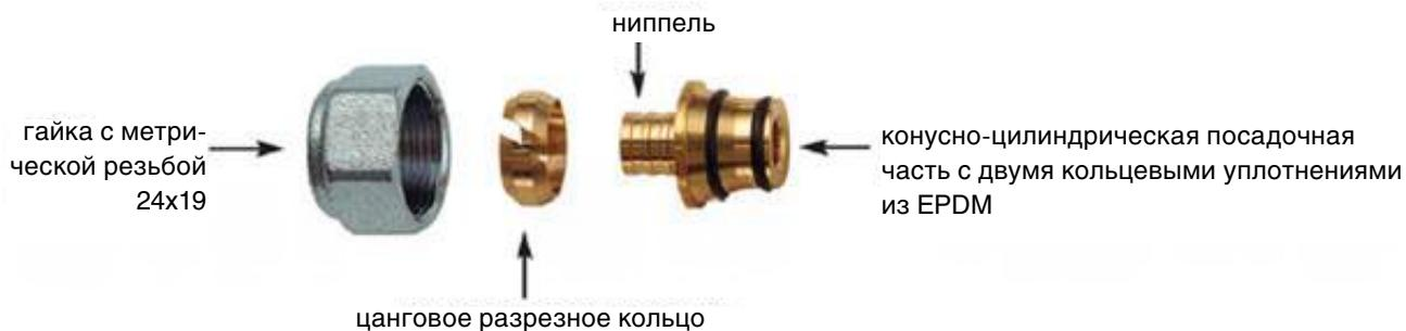
Концовки FAR позволяют подсоединять **напрямую медные трубы** диаметром от 10 мм до 22 мм включительно. Конструктивно концовки для медных труб представляют собой резиновые втулки из EPDM на внешнюю поверхность трубы. Их конусообразная форма сопрягается с присоединительным штуцером арматуры FAR с метрической резьбой.
