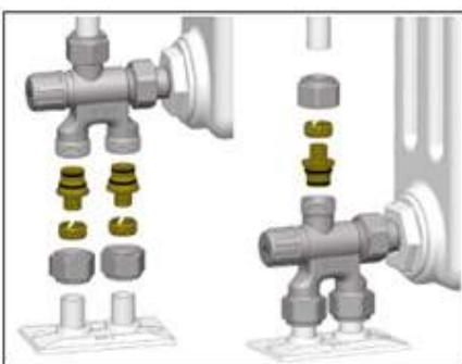
Пример установки с использованием концовок (код 6052) для труб PEX.
