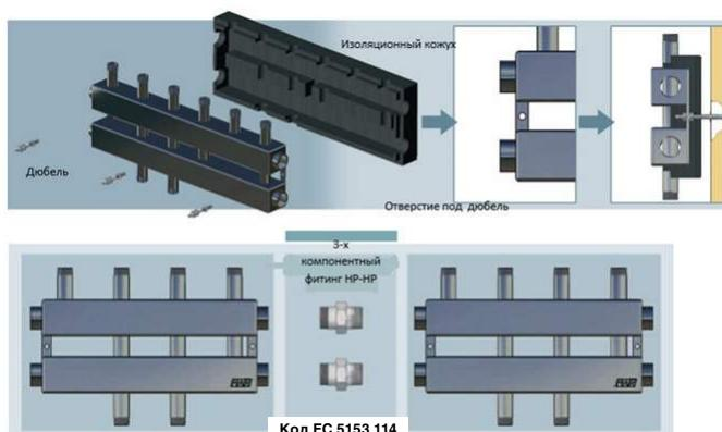
Коллекторы могут собираться до требуемого количества потребителей с помощью трехкомпонентного фитинга с наружными резьбами 1"1/4.
