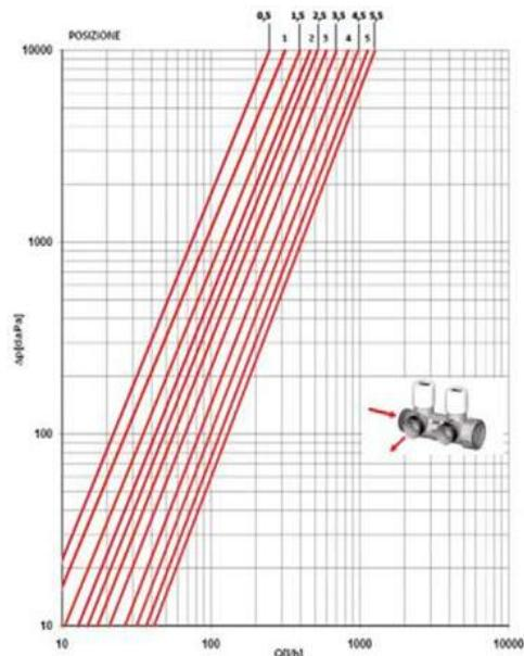
Вентиль позволяет произвести плавную и точную балансировку каждого контура в диапазоне пропускной способности от 0,3 до 1,2 м<sup>3</sup>/ч.
