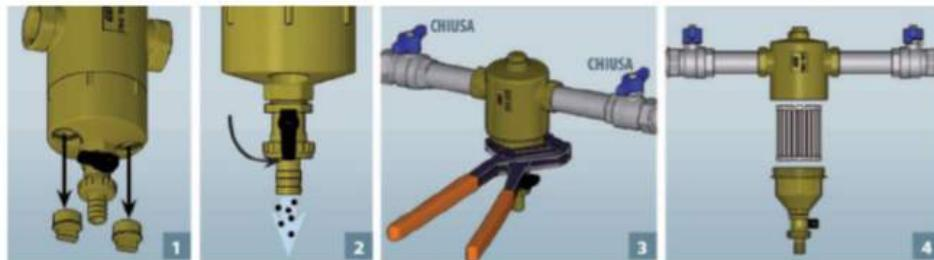
Требуется периодически очищать внутренний фильтр. Для этого закрываются шаровые краны, отвинчивается нижняя часть корпуса с помощью газового ключа и вынимается картридж. После очистки картриджа вставьте его на место и завинтите нижнюю часть корпуса.
