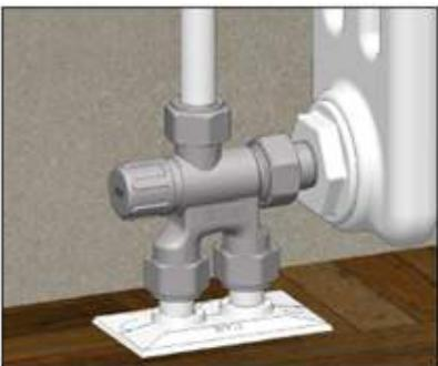
Пример установки узла с использованием терmostатической головки.
