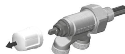
Отводы для присоединения к отопительной системе имеют метрическую резьбу FAR M24x19. Подключение металлопластиковых, пластиковых и медных труб осуществляется при помощи концовок FAR: Код 6055 – для металлопластиковых труб PEX диаметром 12-20 мм Код 6052 – для пластиковых труб диаметром 12-20 мм Код 8427, 8429, 8850 – для медных труб диаметром 10-22 мм
