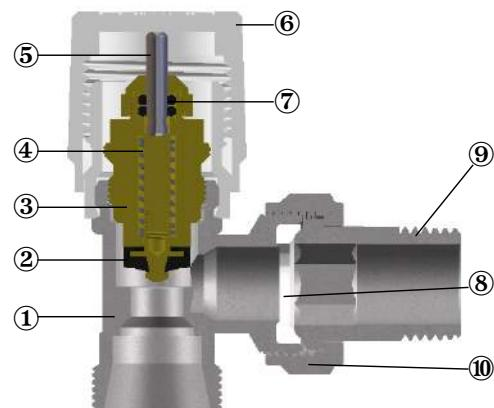
Терморегулирующий вентиль снабжен пластиковой регулирующей ручкой и может быть установлен вместо традиционных регулирующих вентилей. Ручная регулировка производится, начиная с полностью закрытого положения, переводом в открытое положение в соответствии с числом оборотов ручки.
