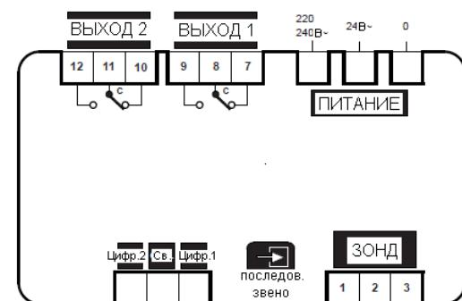
Зонд температуры потока должен подключаться к клеммам с маркировкой **зонд № 2 и 3**.
