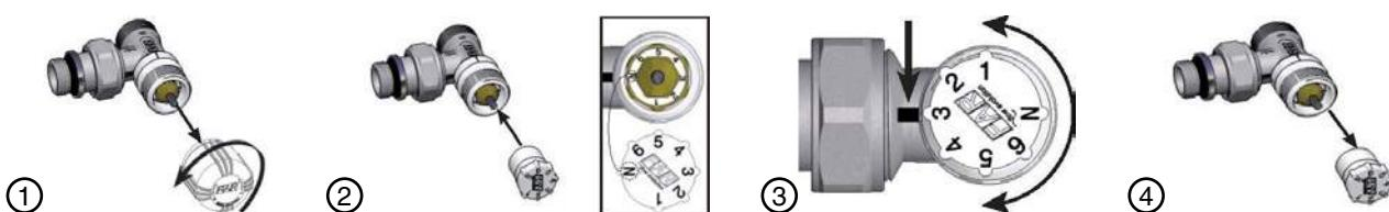
После установки регулирующей ручки или термостатической головки предварительная настройка становится закрытой от неавторизованного изменения.
