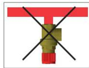
Сбросные трубы не должны мешать нормальной работе клапана, а сбрасываемая вода не должна наносить ущерб людям и имуществу.
