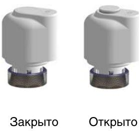
В нормально закрытой электротермической головке при отсутствии тока вентиль находится в закрытом положении и открывается при подаче электрического сигнала от комнатного термостата. В нормально открытой электротермической головке при отсутствии тока вентиль находится в открытом положении и закрывается при подаче электрического сигнала от комнатного термостата.
