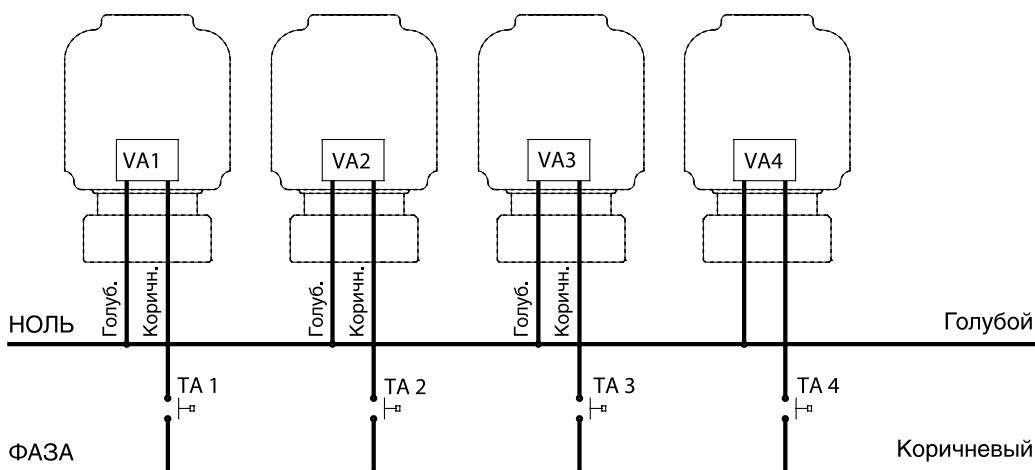
**Электротермический привод обеспечен двумя проводами:**
