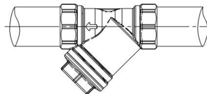
Муфтовые соединения должны выполняться с использованием в качестве уплотнительных материалов ФУМ (фторопластовый уплотнительный материал).
