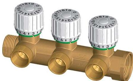
Коллекторы FAR (арт. 3815) со встроенными балансировочными клапанами с функцией преднастройки на каждом отводе предназначены для управления расходом воды к каждому потребителю в системах отопления и охлаждения (например, фэн-койлов). Коллекторы могут устанавливаться на подающий или отводящий трубопровод.
